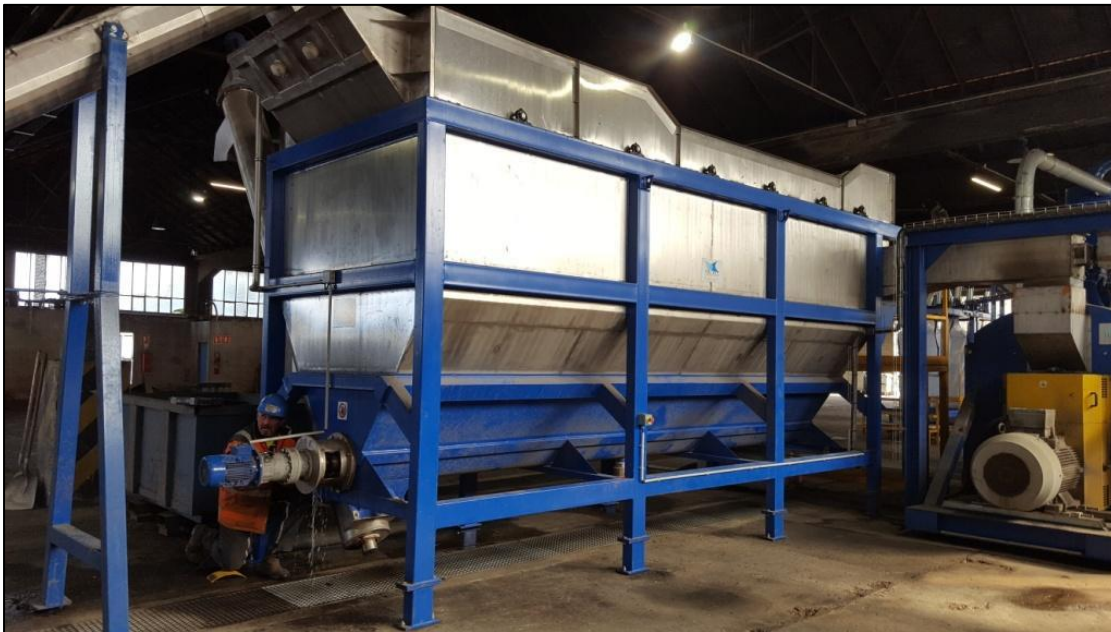
Bac de décantation flottation
